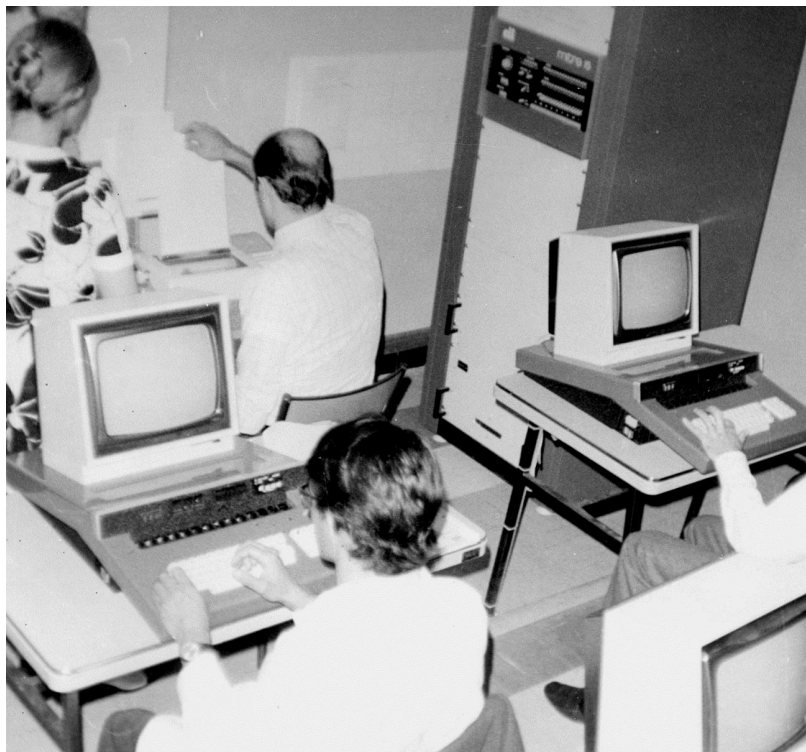
FIGURE 1. Le Mitra 15 était accompagné de 8 consoles de visualisation permettant un travail en binôme. L'impression se faisait sur un télétype (ASR 33) collectif pourvu d'un lecteur-perforateur de ruban permettant d'entrer et de sauvegarder programmes et données. L'entrée de la « galette » LSE prenait plus d'une heure. Ce n'est pas là mon souvenir le plus agréable. Au lycée de La Celle Saint-Cloud en 1973. On ne voit pas le lecteur de ruban à gauche du télétype. Il a fallu attendre 1977 pour que le lycée soit doté d'un disque souple ( floppy disk ).
