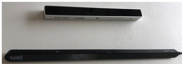
FIGURE 4. Deux des oculomètres qui permettent de jouer avec GazePlay : l'Eye Tribe en haut, le Tobii 4C en bas.
